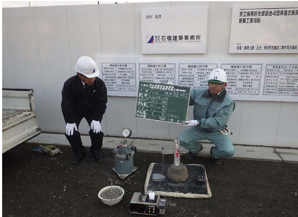
撮影内容 3 A工区 基礎・地中梁CON受入検査
